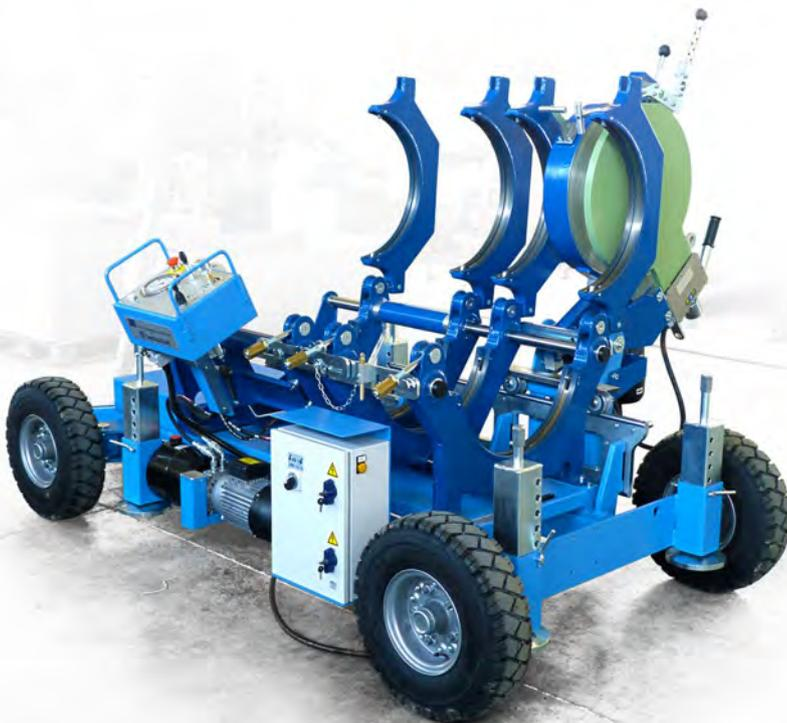
Linea cantiere-pressione - Trench Welding Machines
