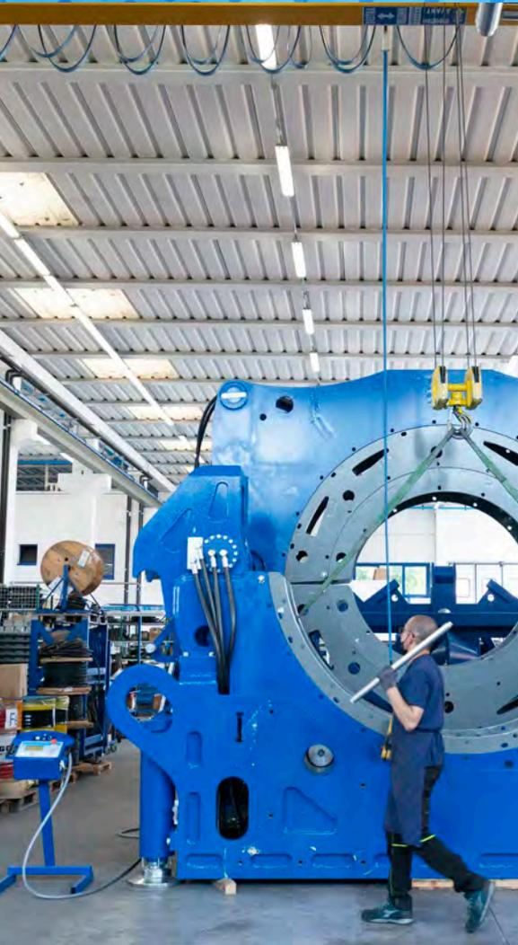
Saldatrici idrauliche per la saldatura testa a testa di tubi e raccordi in PE, PP, PVDF e altri materiali termoplastici per condotte in pressione.
